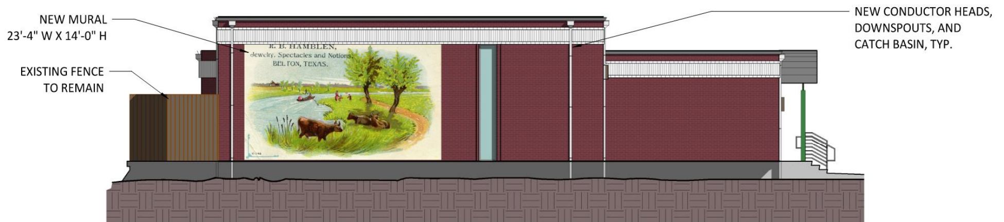
④ EAST ELEVATION SCALE: 1/8" = 1'-0"
