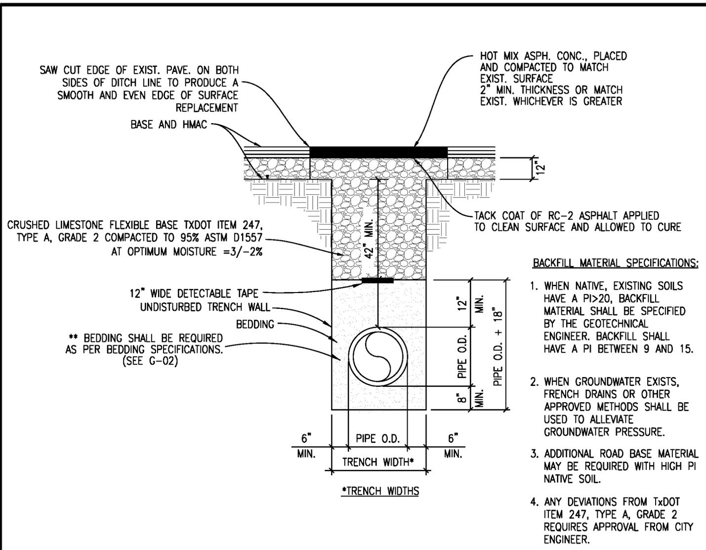
**BACKFILL MATERIAL SPECIFICATIONS:**
